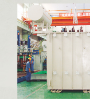
Rectifier Transformer 50000.KVA
